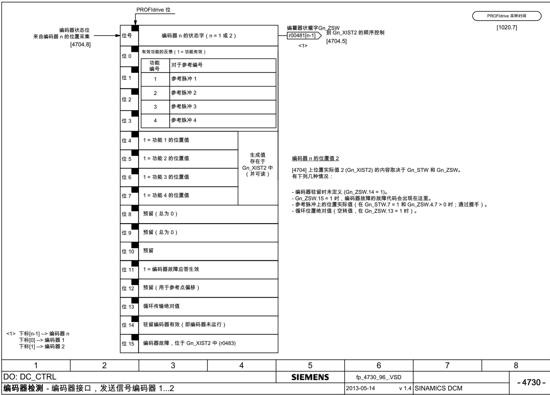
图 2-74 4730 - 编码器间接接口，发送信号编码器 1...2
