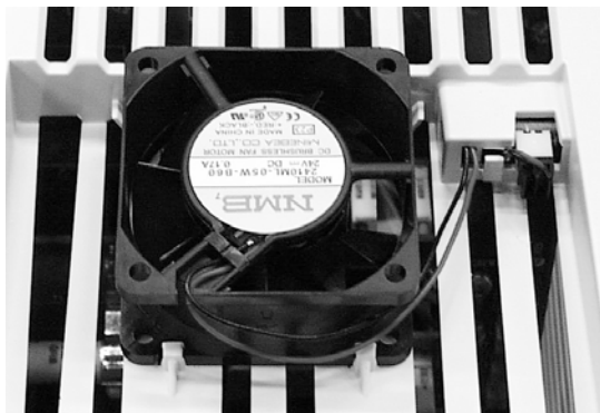
拆下前盖，风机顶部。
